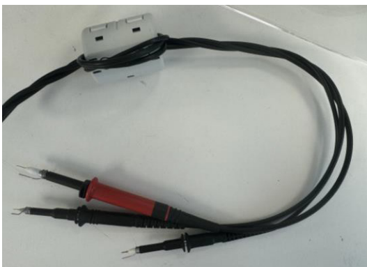
图 32. 将线缆扭转，并使用铁氧体磁芯过滤共模栅源噪声
