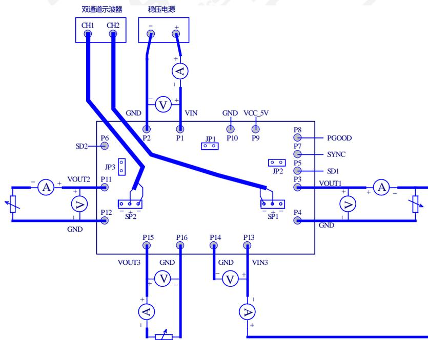
ISL6441EVAL 输入电压范围是 4.5v-24v,但这里所指的输入电压范围 4.5v-24v 被划分成两个区间, 4.5v-5.6v 和 5.6v-24v。
